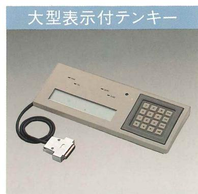
40文字4行LCD表示付。PCを遠隔から操作するために、大型LCD表示を搭載。
